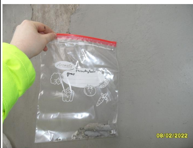
Foto 6: Rückseite der Stallungen Probe: Fassadenfarbe, grau
