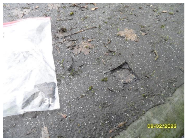
Foto 12: Dach der Stallungen - KMF haltige Dachbahn Probe: Schwarzpappe Robbengehege
