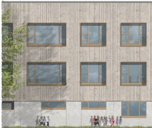
Abbildung b (links, Ansicht) und c (rechts, Detail-Schnitt): Geplante Ausführung eines umlaufenden Fenster- bzw. Leibungsrahmens als brandsperrenähnlichen Konstruktion analog zu „hinterlüftete Außenwandbekleidungen“ gemäß VV TB NRW, Anhang 6, Abschnitt 4.5 Öffnungen
