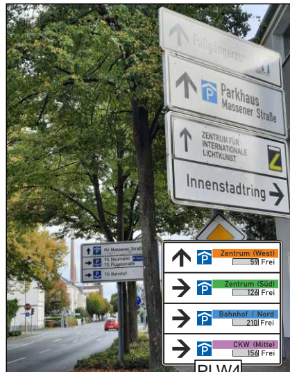
7 (digital) Linken Parkleitwegweiser mit neuem PLW4 ersetzen. Rechten Wegweiser reduzieren, eindrehen und Hinweis auf P-Messener Str. entfernen.
